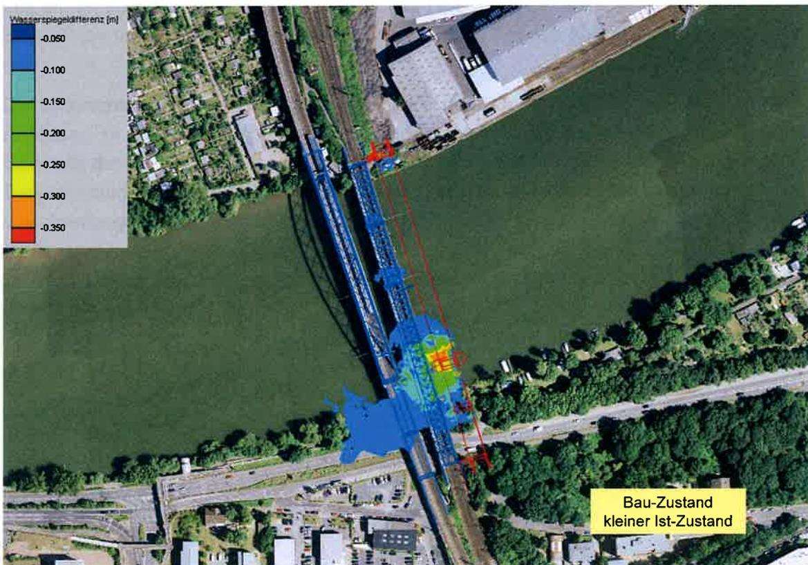
Abbildung 11: Wasserspiegeldifferenzen bei  $HQ_{100}$  (Bau-Zustand minus Ist-Zustand)
